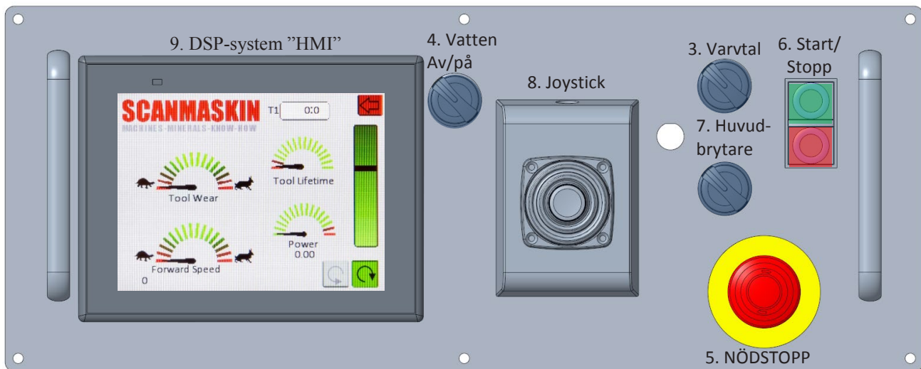
Figur 4-3 Kontrollpanel för SCANMASKIN 32 WS RC
