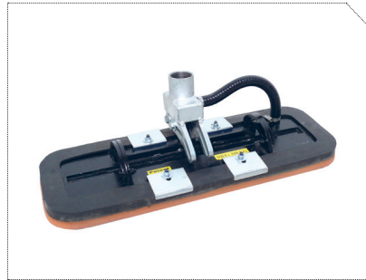
KANTSTENSSUGEKOP 230X670 MM, JUSTERBAR VINKEL 0-90°, WLL 350 KG
